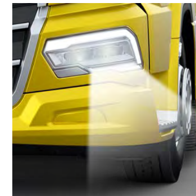
LED-LEUCHTEN MIT ABBIEGELICHT
